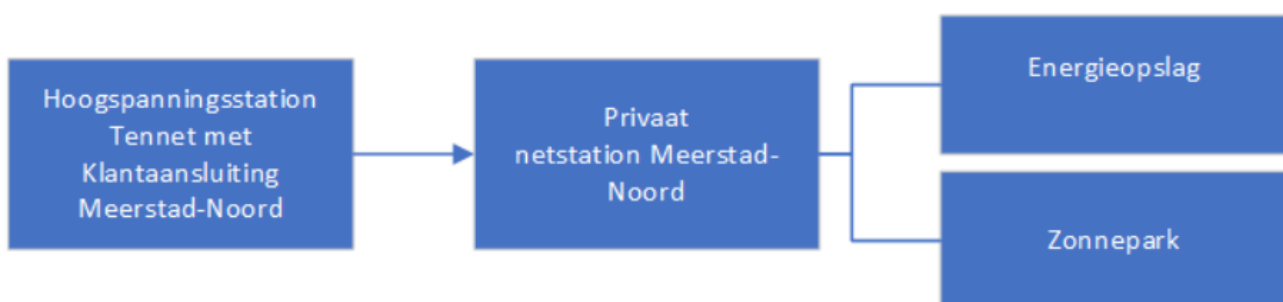
Schematische weergave netaansluiting en privaat netstation Meerstad-Noord
