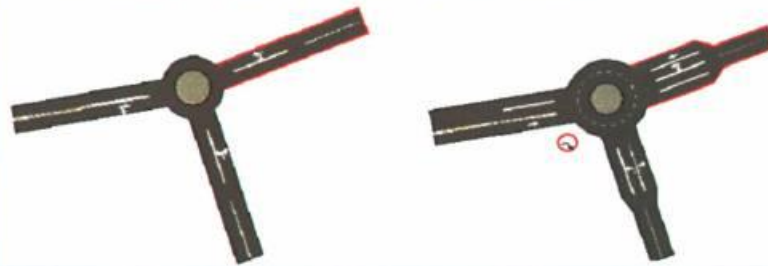
Wegvak Kielerbocht - afslag Westerbroek: Wegvak verbreed van een 2x1 naar een 2x2 profiel.
