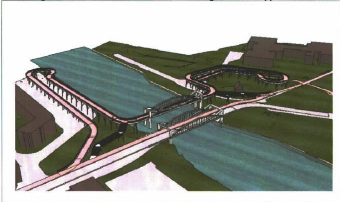
Afbeelding 4.4. 3D-visualisatie variant A3 met hellingbanen en trappen voor fietsers
